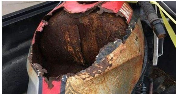
Gambar 2. Korosi karat yang destruktif pada tangki motor. (Sumber : Instagram/@outtoride, 2021) Diakses pada : 08 Januari 2021.
