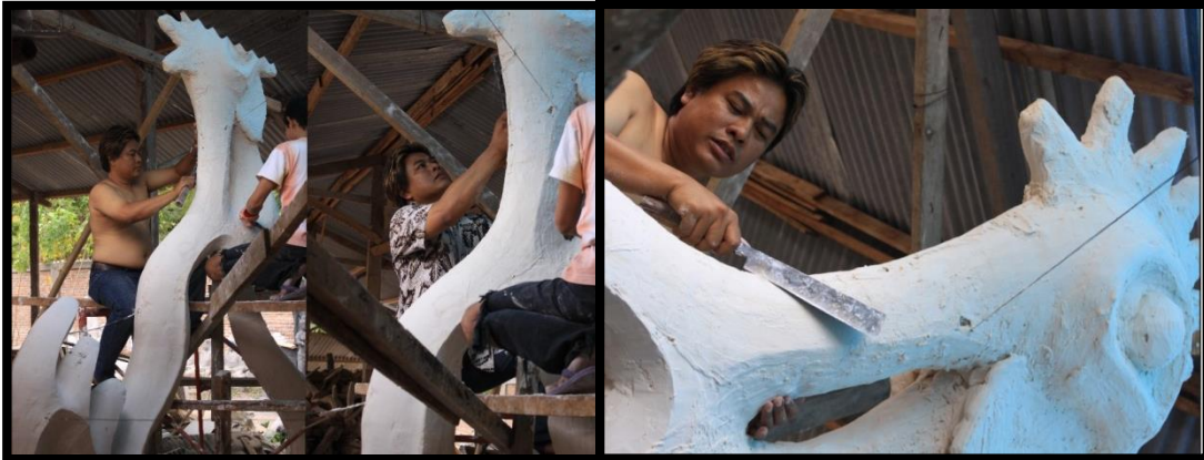
Gambar 14 . Proses pembuatan model
