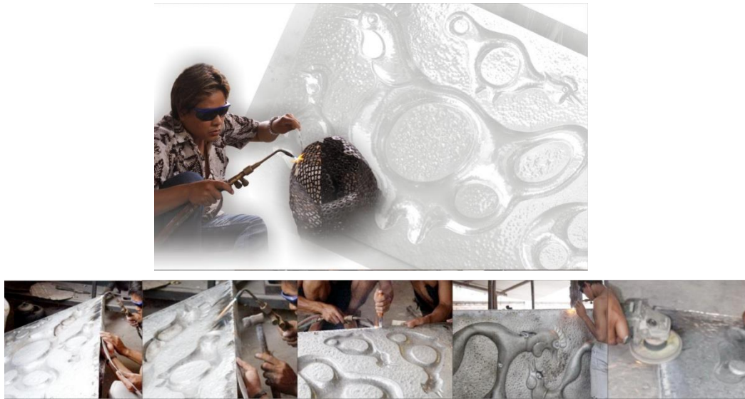
Gambar 15 . Proses pengelasan dan pembentukan
