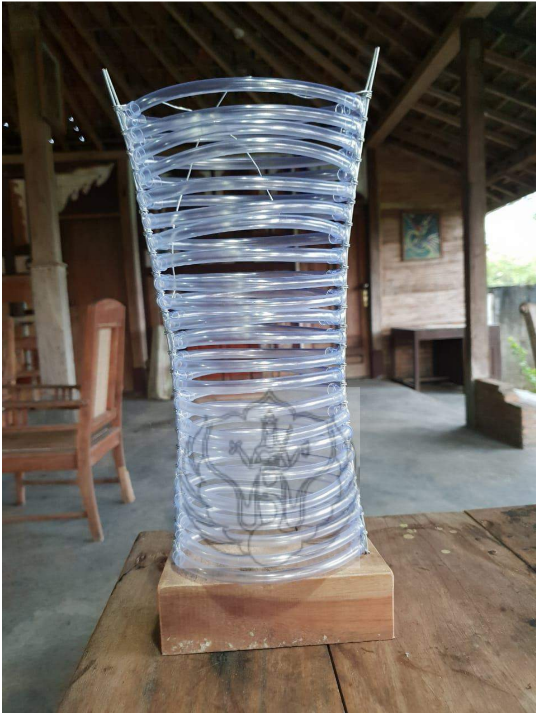
Gb. 6. Mock up atau model instalasi dari bahan slang plastik untuk kultivasi mikroalga pada photobioreactor (PBR).
