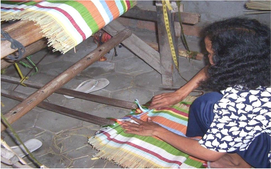
Gambar 53. Proses melepas hasil tenun dari penggulung kain
