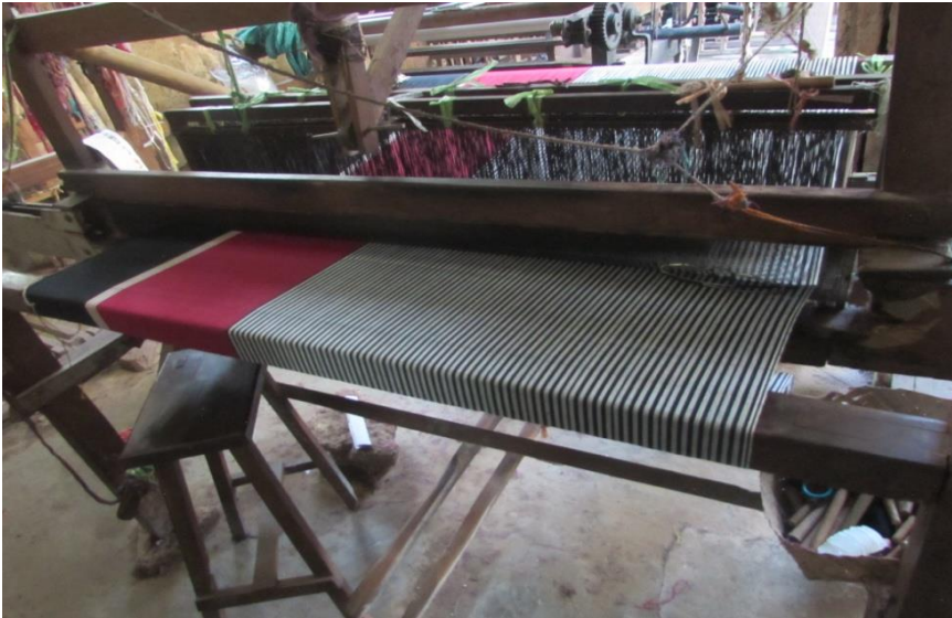
Gambar 11. Goyangan ATBM yang Berfungsi untuk Merapatkan Tenunan
