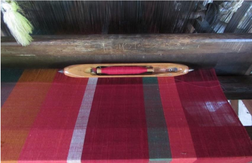
Gambar 18. Teropong berfungsi untuk menyimpan dan mengantarkan benang pakan ke kanan dan ke kiri disela-sela persilangan benang lungsi.
