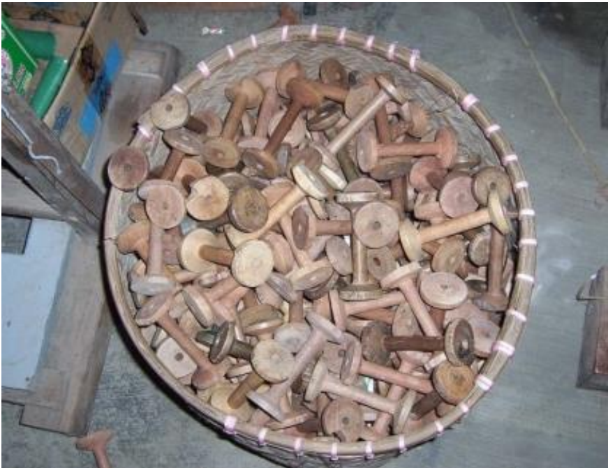
Gambar 32. Kelos terbuat dari kayu
