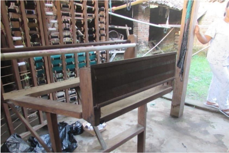
Gambar 15. Sisir Kres alat ini merupakan alat yang berfungsi untuk menata benang lungsi sekaligus menyilangkan benang lungsi antara benang yang bernomor ganjil dengan benang yang bernomor genap, hal ini dilakukan agar proses penganyaman benang pakan pada proses penenunan bisa berjalan dengan sempurna.
