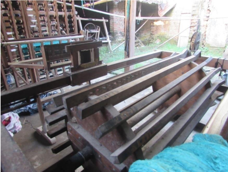
Gambar 17. Boum Besar, berfungsi sebagai penggulung benang lungsi sekaligus menata benang lungsi sesuai dengan lebar kain tenun yang akan dikerjakan.
