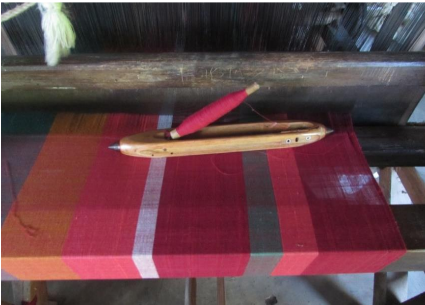
Gambar : 19. Palet yang sudah terpasang pada teropong.
