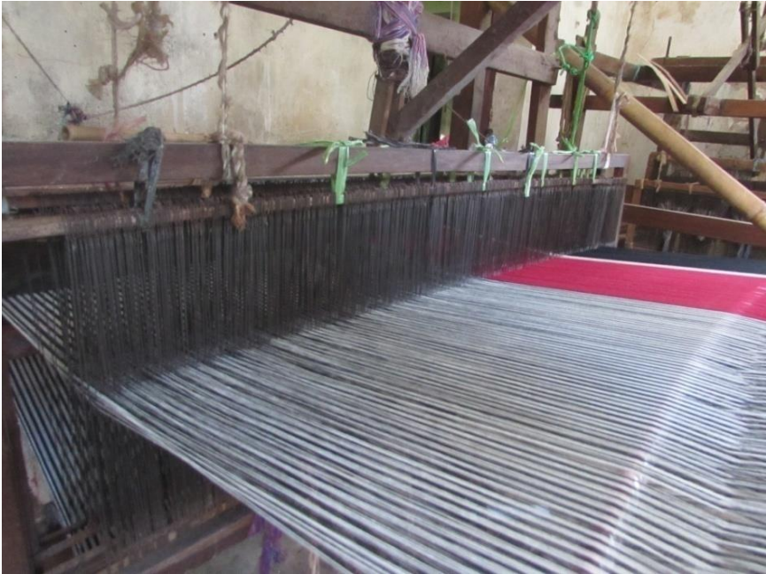
Gambar 9. Sepasang Gun yang berfungsi untuk menaikkan dan menurunkan benang lungsi pada proses penganyaman benang pakan.
