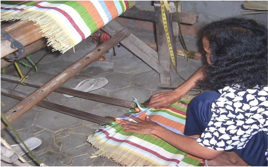
Gambar 53. Proses melepas hasil tenun dari penggulung kain
