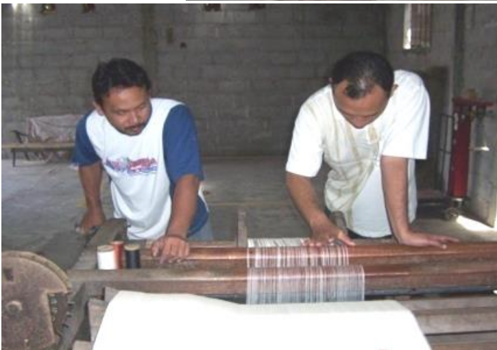
Gambar 44. Pemindahan benang lungsi dari boom bear ke boum kecil
