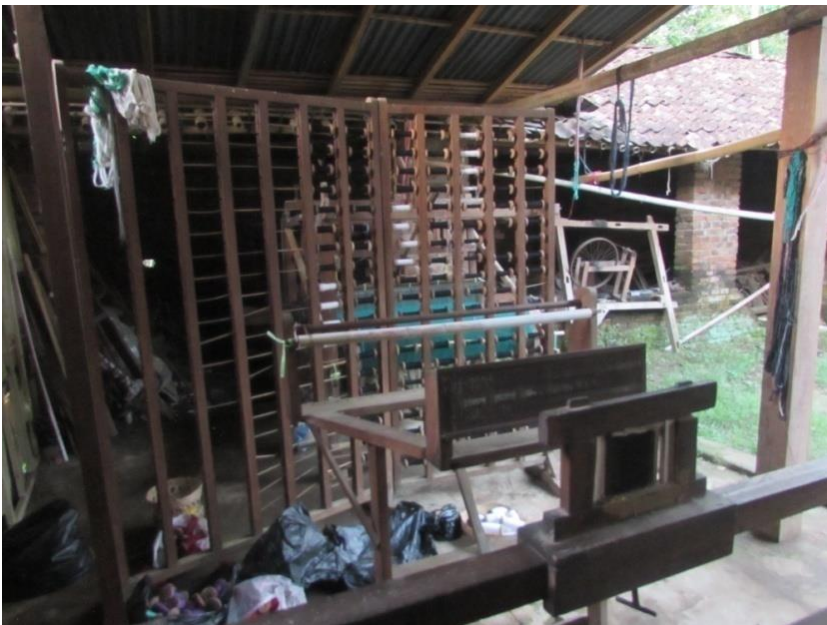
Gambar 16. Sisir atau Suri, Sisir ini berfungsi untuk menata atau mengatur alur benang lungsi sekaligus menata lebar susunan motif kain yang akan dikerjakan menuju penggulungan atau boum besar.
