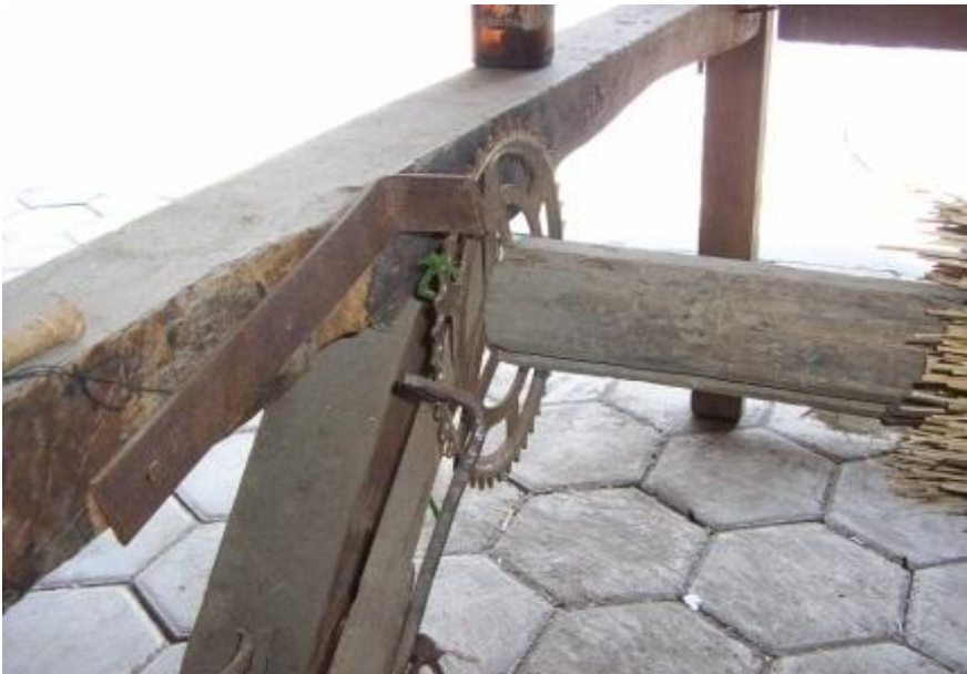
Gambar 51. Proses penggulungan dari boum kecil ke penggulung kain
