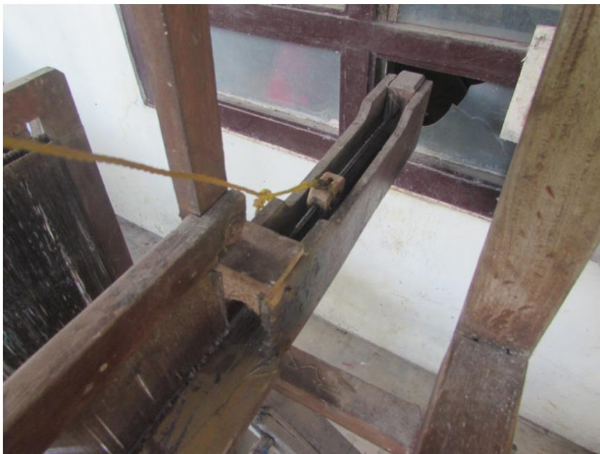
Gambar 12. Laci Teropong yang berfungsi sebagai tempat teropong sebelum teropong tersebut meluncur ke kanan dan ke kiri disela-sela silangan benang lungsi. Teropong bisa meluncur karena kena terdorong oleh peker.
