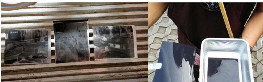
Gambar 13. Hasil ujicoba penggunaan BPU di dalam ruangan, gambar terlihat normal (kiri) dan di luar ruangan, gambar tidak terlihat (kanan)
