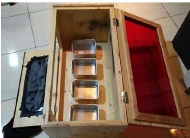
Gambar 8. BPU dan kelengkapannya dalam kondisi terbuka
