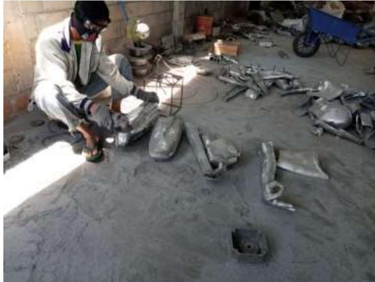
Gambar 15. Proses pengamplasan bagian samping. (Foto: Ranu Marfa, 2020).
