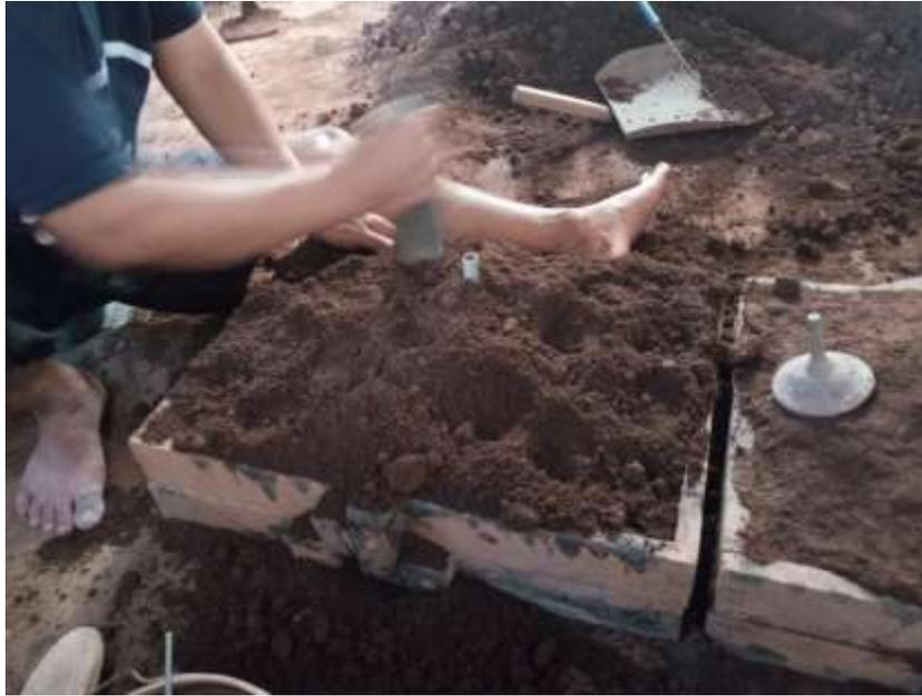
Gambar 13. Proses memasukkan tanah di cetakan. (Foto: Ranu Marfa, 2020).
