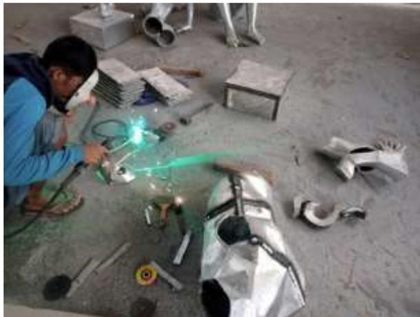
Gambar 18. Proses penyambungan dengan alat mesin las dan bahan pembantu (tenol).
