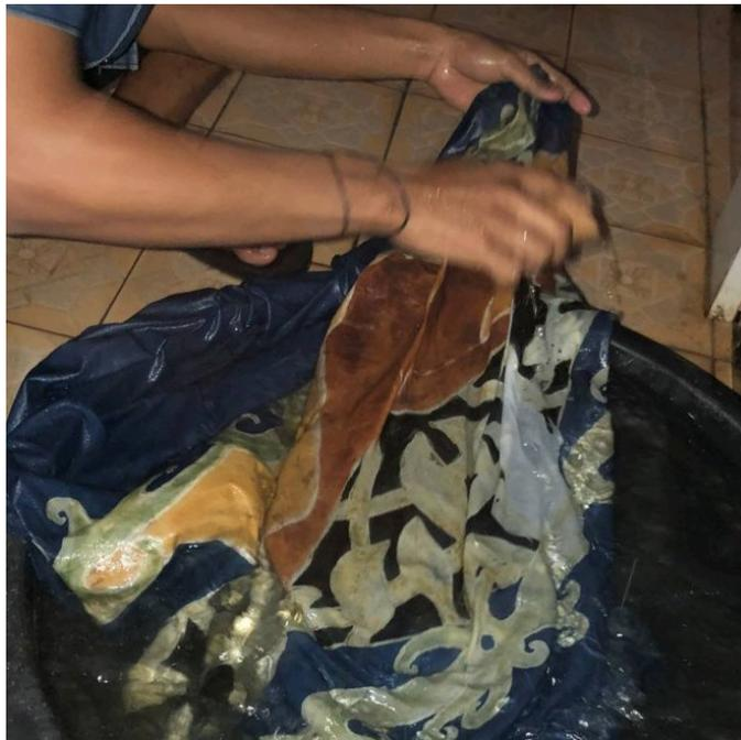
Gambar 3.78 Proses *ngelorod* kain untuk busana *scarf outer 3*
