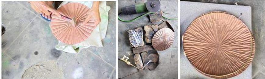
Gambar 3. Mengukir tembaga, penyambungan dengan las dan konstruksi untuk mengikat serat.
