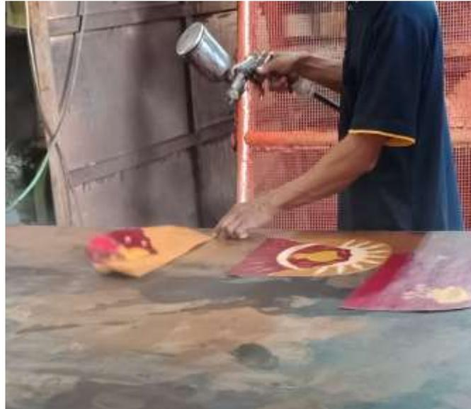
Gambar 81. Proses Penyemprotan Lak Sebelum Setrika
