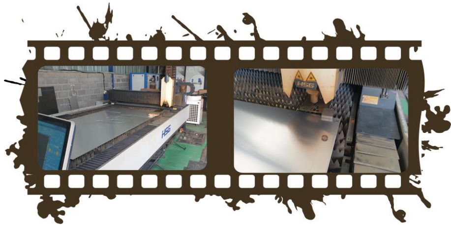
Gambar 54. Proses pemotongan logam dengan mesin cutting laser Fotografer: Wisnu Febriyanto
