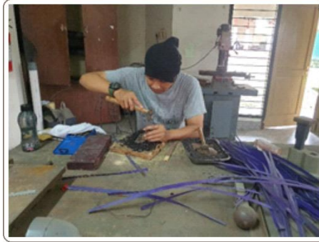
Gambar 51. Pembentukan dan dekorasi logam dengan Teknik ukir logam Fotografer: Wintu Marjuki
