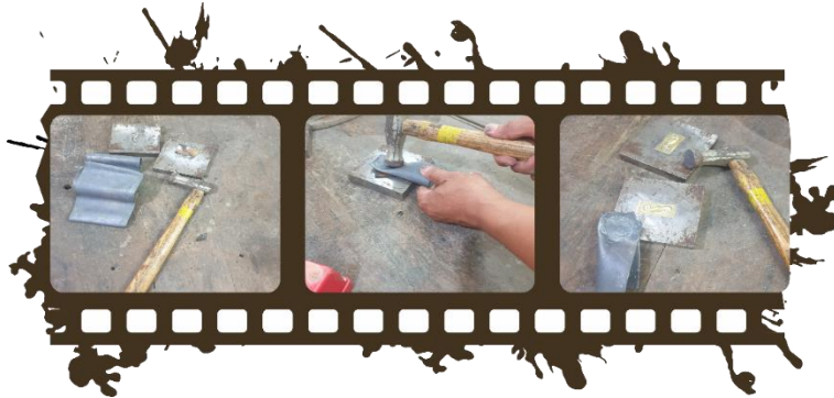
Gambar 52. Proses kerja pengempaan bentuk parang dengan menggunakan teknik drag Fotografer: Wintu Marjuki
