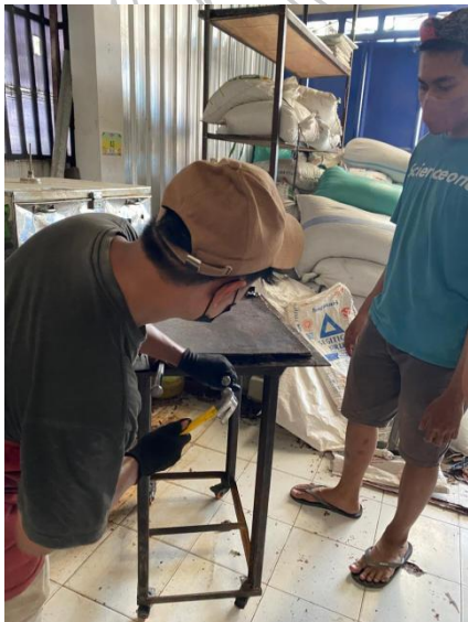
Gambar 53. Proses pengeluaran papan plastik (Sumber: Khansa, 2024)
