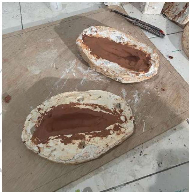
Gambar 3. 31 Proses Cetak Tekan (Sumber: Fahmi, 3 Maret 2025)
