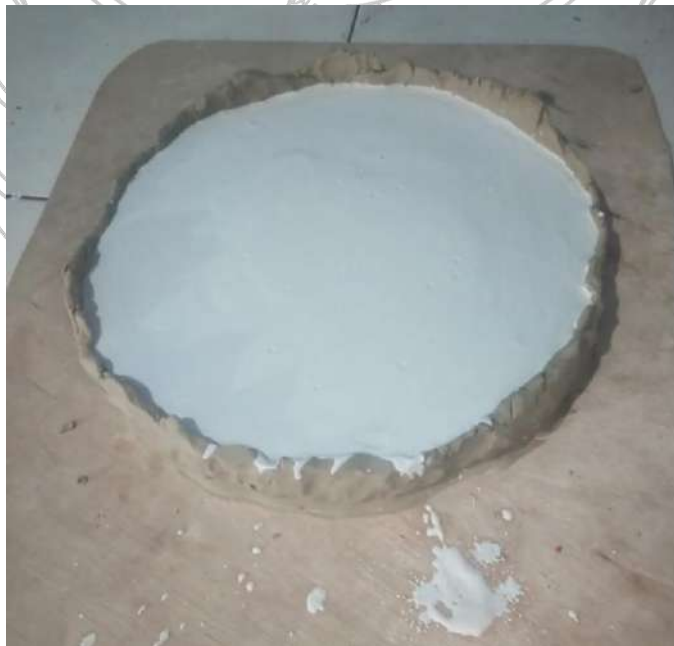
Gambar 3. 30 Proses Pembuatan Cetakan (Sumber: Fahmi, Difoto 20 Febuari 2025)
