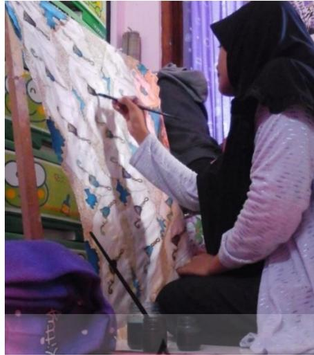
Gambar 1. Proses pewarnaan colet menggunakan pewarna remasol pada kain batik.
