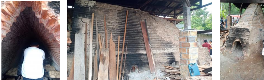
Gambar 3. Bentuk tungku belalai gajah ( elephant trunk kilns ) yang mengadopsi bentuk tungku gua atau tungku sarang rayap peninggalan nenek moyang masyarakat pengrajin keramik Mokkhalan (Sumber: Dokumentasi Penulis, diambil 2 Agustus 2023)
