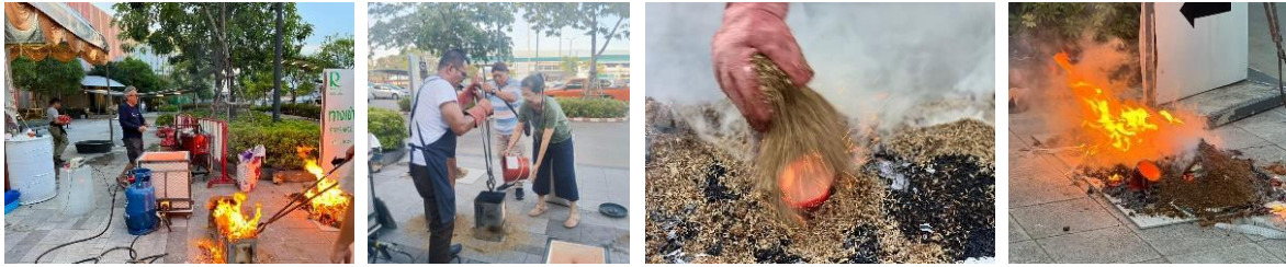
Gambar 12. Raku firing test kekuatan tanah Mokkhalan ( shocking temperature/ thermal shock ) dan aplikasi finishing alternatif dengan pembakaran yang singkat dan artistik (Sumber: Dokumentasi Penulis, diambil 5 Agustus 2023)
