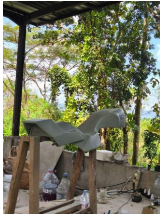
Gambar 4.51 Proses Dempul Body Motor dan Pengaplikasian Cat Primer
