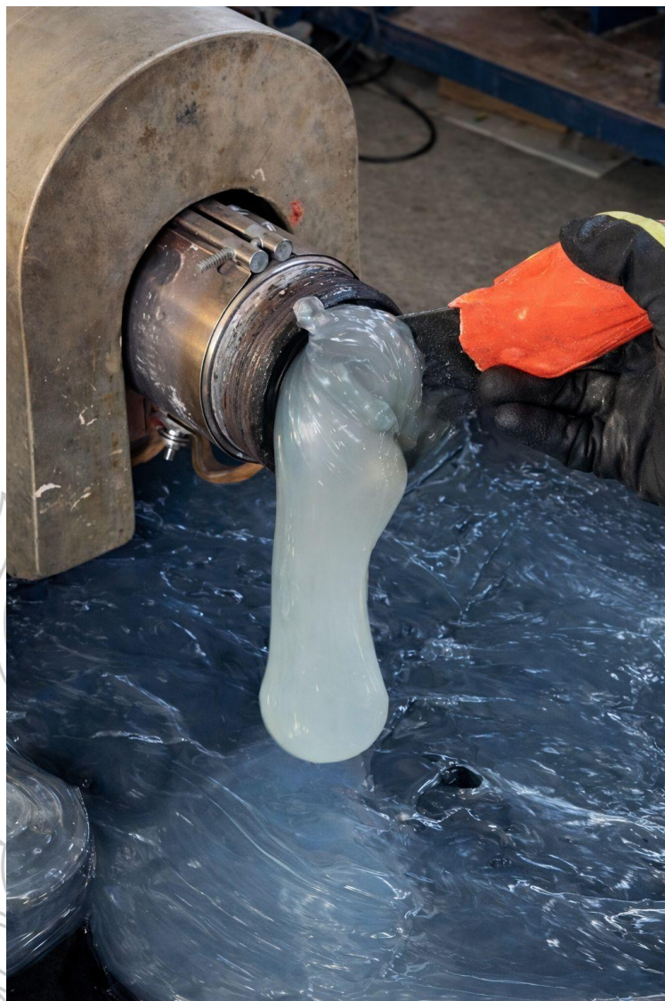
Gambar 5.1 Pembuatan Sheet Polypropylene (Sumber: Instagram Ecollabo8 2025)
