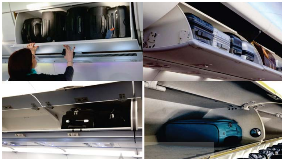
Gambar 26. Contoh Beberapa Bentuk Bagasi Pesawat dan Cara Membukanya Ke bawah (atas) dan Ke atas (bawah) (sumber: www.google.com/dimension/cabin/luggage/room Diakses penulis pada tanggal 1 Mei 2017, jam 23.09 WIB)
