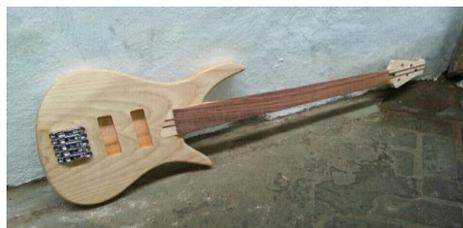
**Gambar 4. Bentuk bass elektrik setelah dihaluskan**
