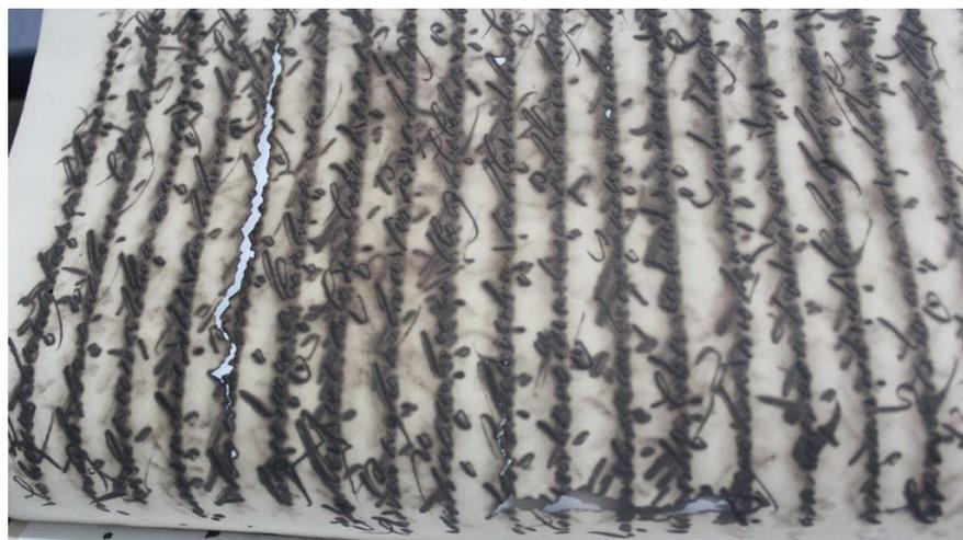
Gambar 4.52 Korosi Tinta pada Serat Menak
