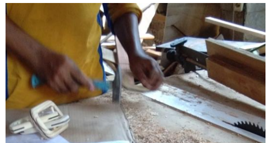
Gambar 28 Proses Produksi 2 Pemakuan Kayu Sonokeling dan Kayu Jati Belanda (Sumber: Dok. Pribadi Pnnulis)
