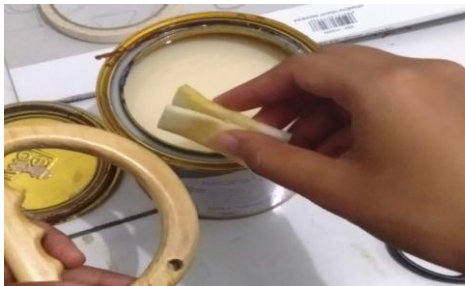
Gambar 32 Proses Produksi 6 Pelapisan Plitur Water Based (Sumber: Dok. Pribadi Penulis)
