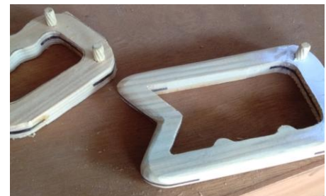
Gambar 29 Proses Produksi 3 Pemasangan Paku (Sumber: Dok. Pribadi Penulis)
