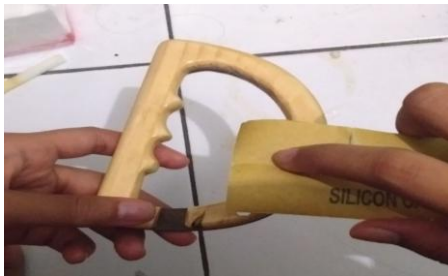
Gambar 31 Proses Produksi 5 Proses Pengamplasan (Sumber: Dok. Pribadi Penulis)
