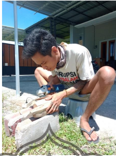
Gambar 4.30 Foto proses pembentukan dan penghalusan menggunakan mesin gerinda tangan (Sumber: Dokumentasi pribadi)
