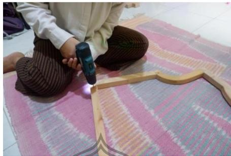
Gb. 15. Proses pelubangan spanram menggunakan bor dengan jarak masing-masing lubang 1,5 sentimeter
