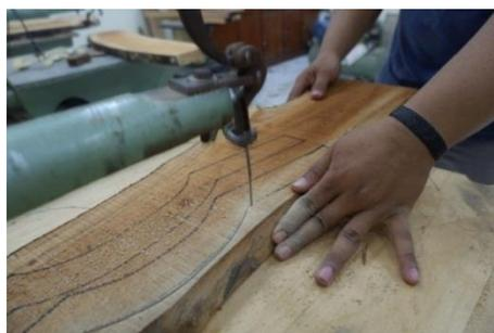
Gb. 14. Salah satu proses pembuatan spanram pada tahap kedua yakni proses pemotongan sesuai dengan mal yang telah digunting
